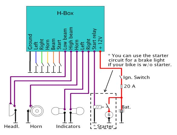
**Tasten - oder Schaltereingang für den Blinker links (Blau):** Hier wird ein Taster, oder Schalter angeschlossen, der den Eingang gegen Masse schaltet. Bei offenem Kontakt passiert nichts, erst beim geschlossenen Kontakt startet der Blinker.
